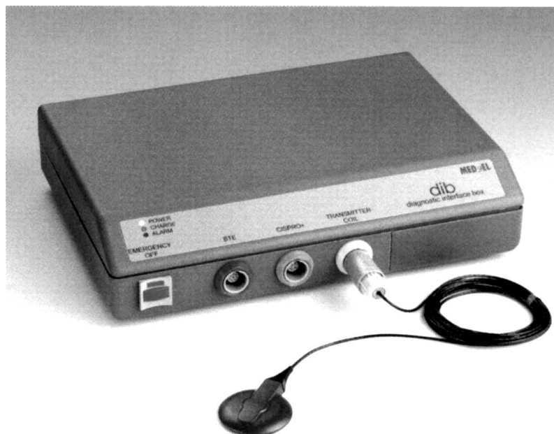
Figura 2.15: Unidad DIB (Diagnostic Interface Box) para conexión del equipo de estimulación y sincronización con el equipo de registro.
