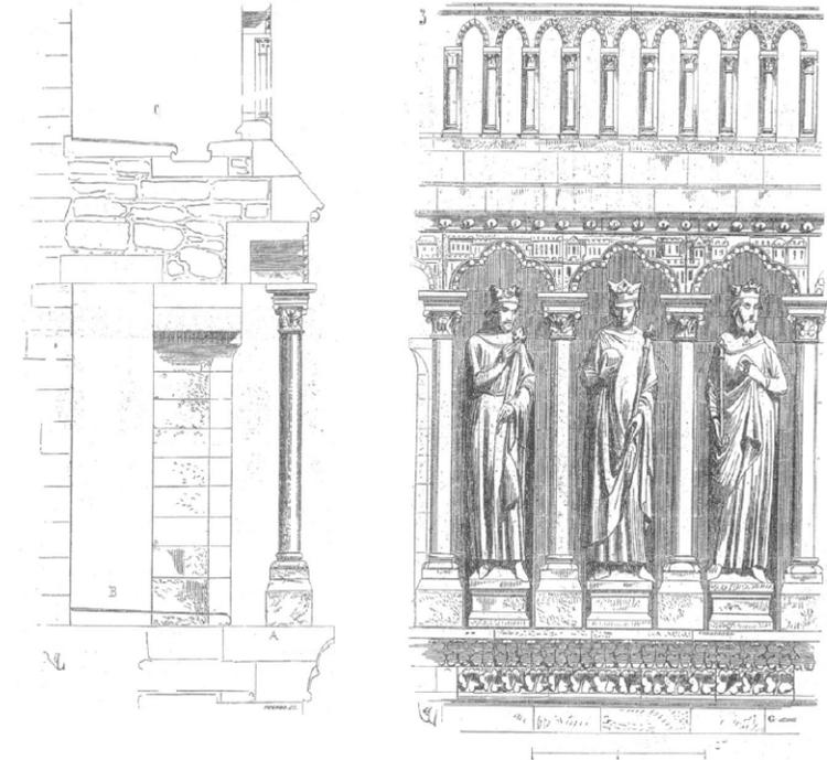
Figura 35. Reparaciones de la Galería de los Reyes realizadas por Viollet-le-Duc y Lassus entre 1845 y 1846 (Fuente: Fonquernie, 1999)
