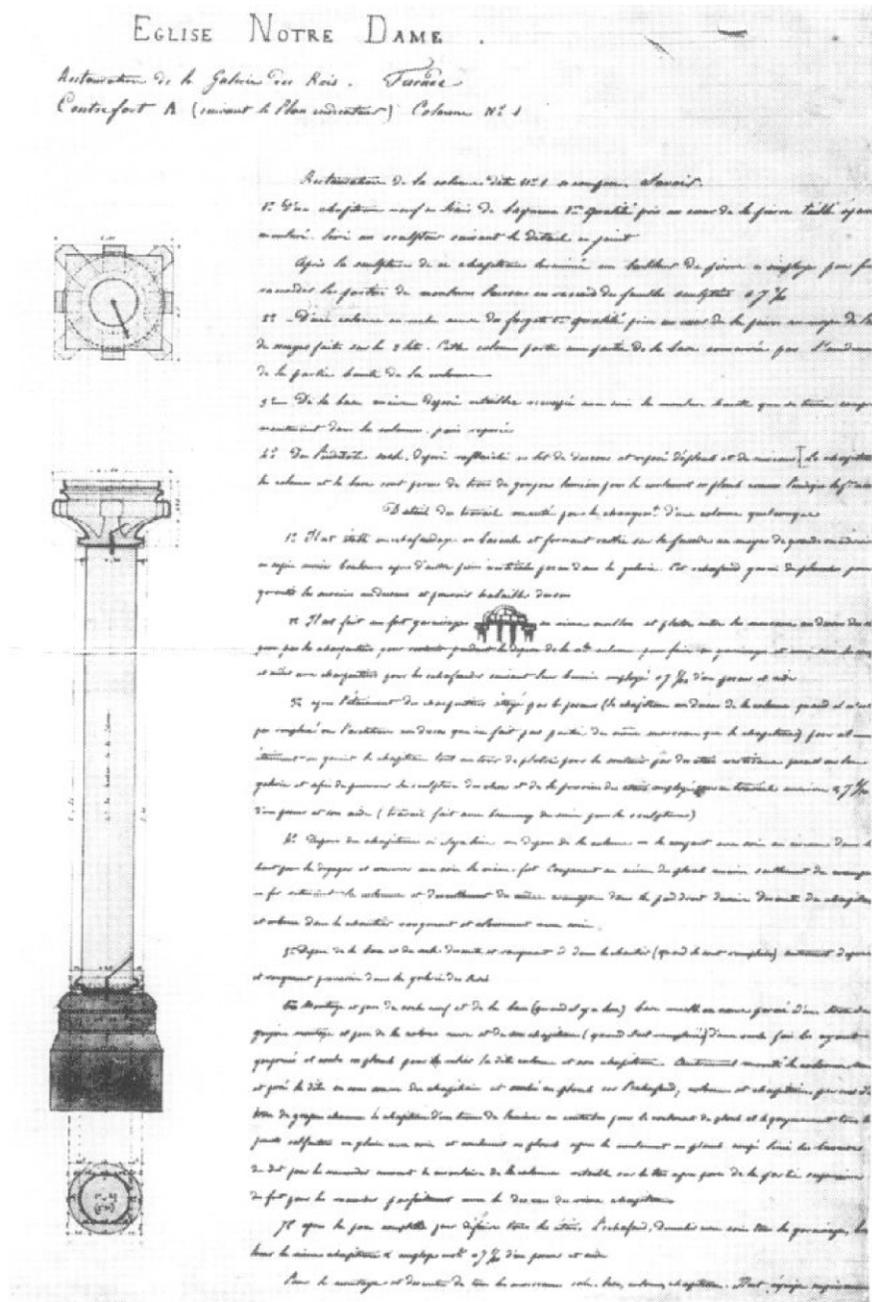
Figura 73. Detalle de las columnas dobles de los nichos del contrafuerte A realizado por Viollet-le-Duc (Fuente: Bulletin Monumental, 1999)
