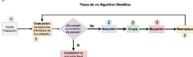
Fig. 2. Fases del algoritmo genético. Fuente: elaboración propia.
