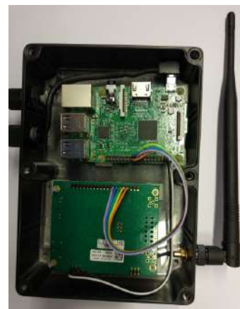
Fig. 7: Conexiones entre el concentrador y la Raspberry Pi.
