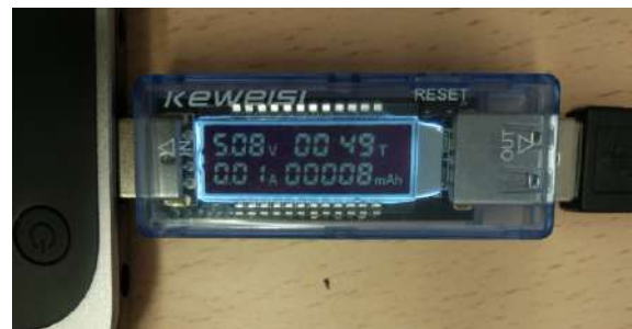
Fig. 10: Medida de la potencia consumida por la mota en un caso realista.
