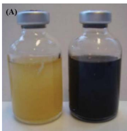
Figura 4. Imagen representativa del cambio de color como consecuencia de la reducción de Pd(II) (izquierda) a Pd(0) (derecha). (Tomado de Foulkes et al. , 2016).
