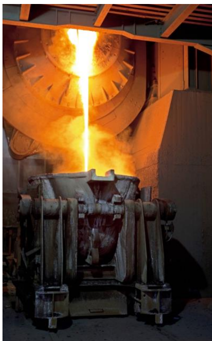
Figura 3. Imagen de una planta de refinería para el reciclaje de metales preciosos mediante métodos de fundición. Fuente https://www.trovaweb.net/images/recupero-affinazione-metalli-preziosi-smaltimento-rifiuti-industriali-chimet-arezzo/recupero-affinazione-metalli-preziosi-smaltimento-rifiuti-industriali-chimet-arezzo-05.png .
