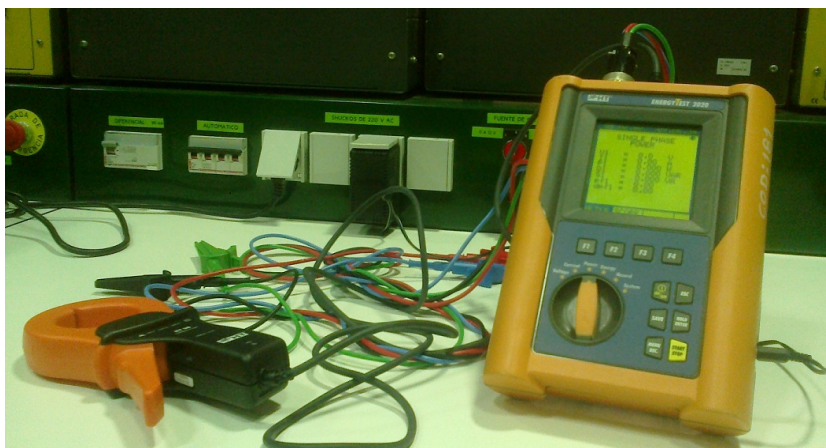
Figure 4.2: Fotografía del analizador de redes a emplear en la práctica.
