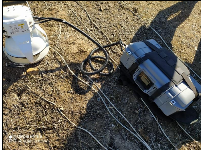
Imagen 3: Fotografía tomada en la parcela experimental del instrumental portátil usado en la medición in situ , el equipo se compone de la cámara 8200-01S, el circuito de aire cerrado y el analizador de gases LI-7810.
