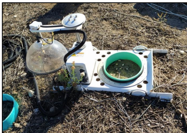
Imagen 2: Fotografía tomada en la parcela experimental de la cámara 8200-104C usadas en la medición en continuo.
