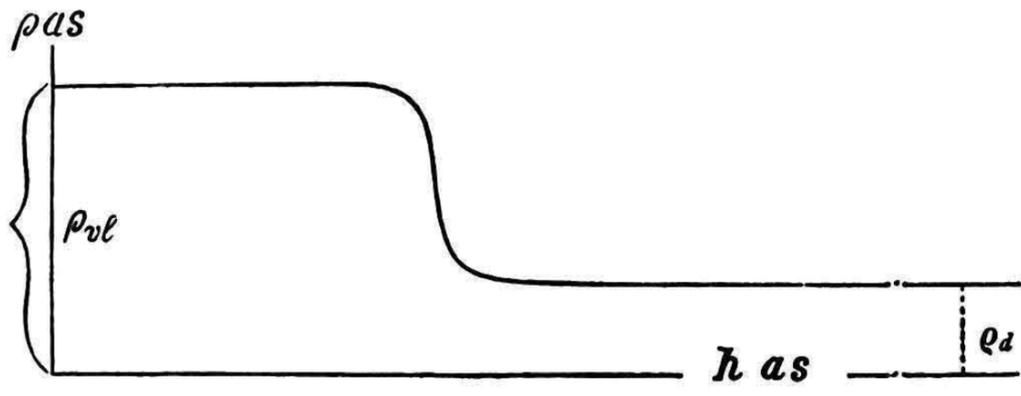
**Figura 6.-** Representación gráfica original del perfil de densidad a través de una interfase de van der Waals en su artículo de 1893.
