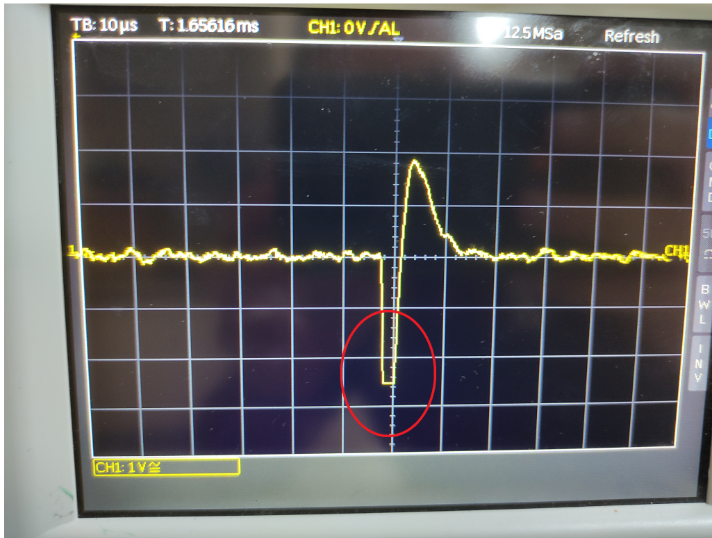
Figura 8: Señal saturada por exceso de amplificación.
