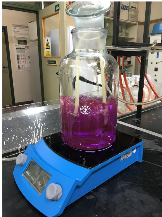
Figura 22. Medio de cultivo en condiciones de anaerobiosis (borboteado con anhídrido carbónico) utilizado para las incubaciones in vitro .
