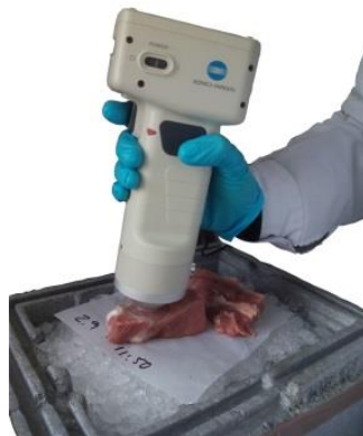
Figura 20. Determinación de las medidas del color.
