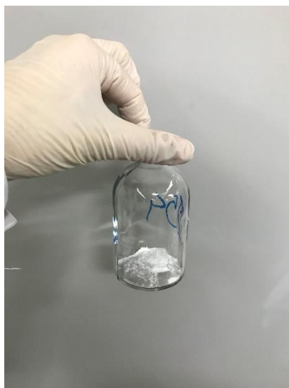
Figura 23. Frascos Wheaton con 200 mg de sustrato.
