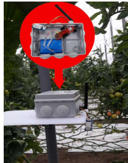
(b) Nodo T_x alimentado por una batería de litio externa
