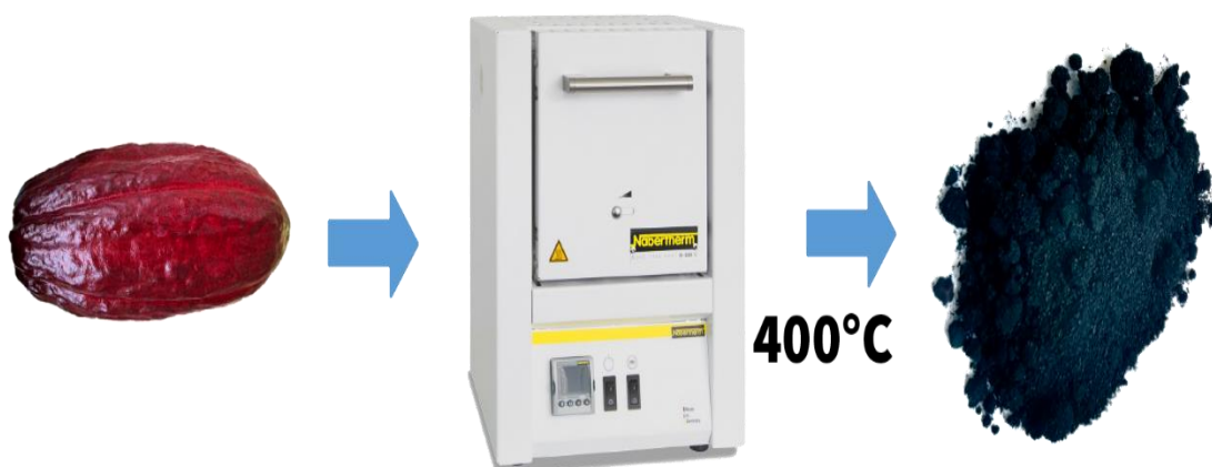
Figura 12. Procedimiento para la obtención de Cacao char
