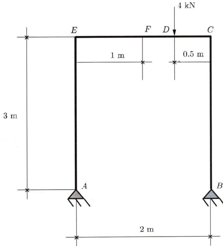
Sabiendo que todos los elementos estructurales tienen la misma sección y son del mismo material, siendo  $EI = 10^4 \text{ kNm}^2$ , se pide:
