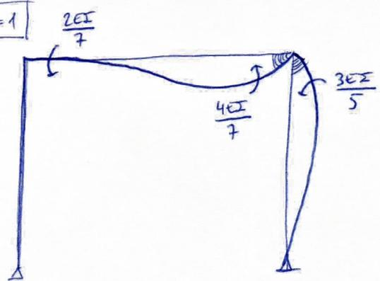
$$(K) = \begin{matrix} & \theta_B & \theta_C \\ \begin{matrix} M_B \\ M_C \end{matrix} & \begin{pmatrix} K_{BB} & K_{CB} \\ K_{BC} & K_{CC} \end{pmatrix} \end{matrix} = \begin{pmatrix} \frac{3EI}{5} + \frac{4EI}{7} & \frac{2EI}{7} \\ \frac{2EI}{7} & \frac{3EI}{5} + \frac{4EI}{7} \end{pmatrix} = \begin{pmatrix} 117143 & 28571 \\ 28571 & 117143 \end{pmatrix} \text{ kNm}$$
