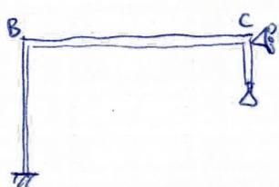
La existencia del apoyo lateral en C impide el desplazamiento horizontal de C. Por inextensibilidad de la viga, B tampoco se desplaza en horizontal. Y por incompresibilidad de pilares, B y C no pueden moverse en vertical.
