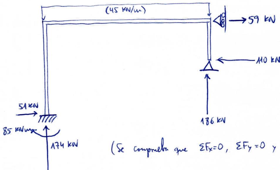
(Se comprueba que  $\Sigma F_x = 0$ ,  $\Sigma F_y = 0$  y  $\Sigma M_A = 0$ )
