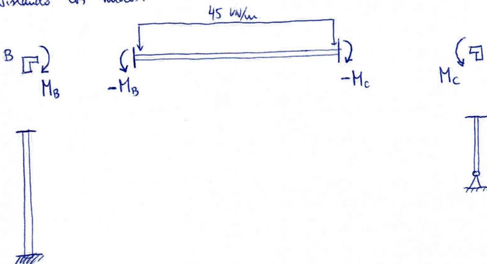
El cálculo de reacciones de empotramiento perfecto en la viga se efectúa mediante el método de proporción. Como la viga es simétrica de geometría, cargas y apoyos, los dos momentos reacción serán iguales y opuestos, y por tanto pueden incluirse en un mismo estado. Al no existir acciones horizontales, no existe tampoco reacción horizontal redundante:
