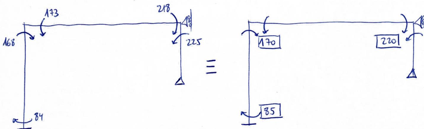
De manera aproximada, se podrá haber evitado realizar la descomposición en la viga simplemente asumiendo que los momentos en sus extremos eran los obtenidos en los pilares.
