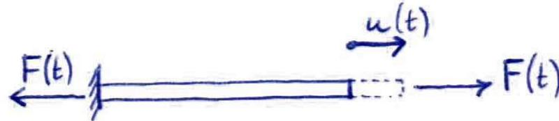
El **trabajo instantáneo** ( $W_I$ ) es el que se ejercería si la pieza alcanzara su deformación máxima “de golpe”, sin pasar por los estadios intermedios:
