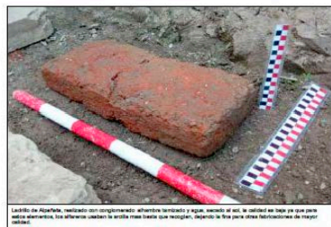
Ladrillo de Alpañata, realizado con conglomerado: arena fina tamada y agua, secado al sol. Se utilizó un molde ya que para estos elementos, los alfareros usaban la arcilla más básica que mezclan, según la fin para otras fabricaciones de mayor calidad.
