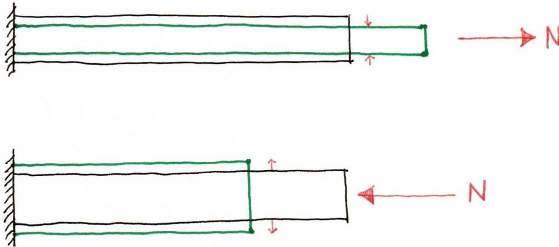
La relación entre ambas deformaciones, transversal y longitudinal, viene dada por el **Coefficiente de Poisson**:
