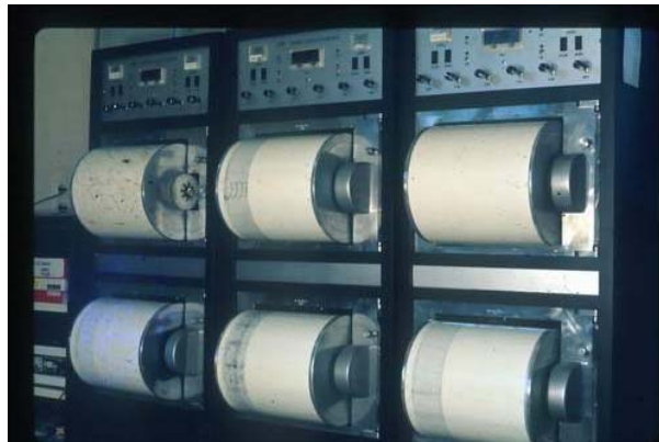
Figura 6.- Registradores en su segunda versión (la primera fue una adaptación de los fotográficos). La electrónica (parte superior) está organizada en tarjetas cableadas entre sí y los conmutadores de los filtros y de ganancia son mecánicos.
