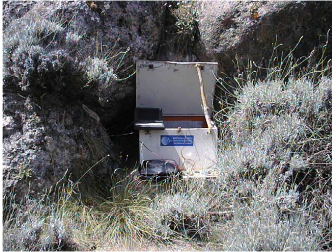
Figura 5.- Caseta de la estación APHE, originalmente designada como HER, en la Sierra de Albuñuelas. En el interior se aloja la batería, el sensor Ranger SS-1 y la electrónica.
