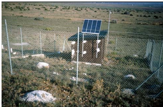
Figura 13.- Una estación de campo de la red local de Almería. Estas estaciones disponen de una infraestructura de obra y de cercado, gracias a la colaboración de la Diputación Provincial de Almería. El registro se centraliza en el campus universitario de La Cañada.
