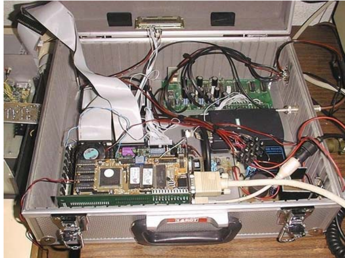
Figura 15.- Estación digital autónoma de registro continuo. Contiene un PC industrial con su disco, el módulo de adquisición de datos, un receptor GPS para el tiempo y un modem para su interrogación telefónica. En el ejemplo que se muestra, el modem es un terminal de telefonía celular GSM para datos.
