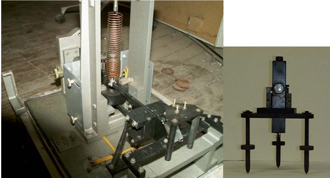
Figura 1.- Izquierda: sismómetro modelo Hiller-Stuttgart vertical sin su tapa. Este sensor funcionó en el Observatorio de Cartuja hasta 1986. Se aprecia el muelle y la masa. En primer término, el eje y el espejo para medida del periodo del péndulo, con ayuda de un anteojo. Derecha: galvanómetro utilizado con este sismómetro. Es el original del registrador de Askania, montado sobre una base exterior.
