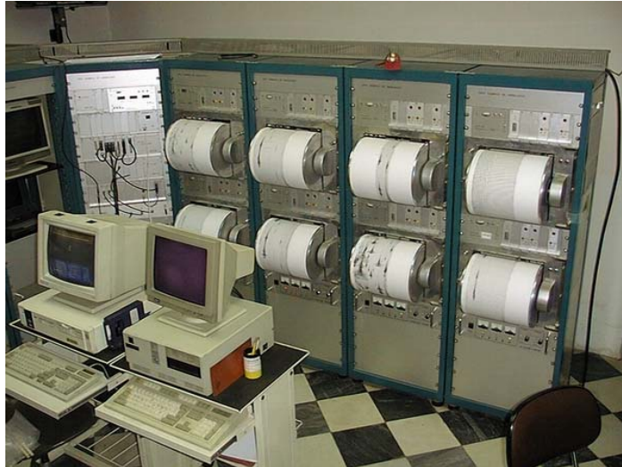
Figura 12.- La central de registro. A la izquierda del grupo de registradores helicoidales, el mueble que aloja el reloj maestro, el oscilador patrón, la interfaz con el GPS y los filtros anti-alias. En la parte baja de cada mueble, la fuente de alimentación ininterrumpida y el sistema de control de los motores de pasos. Los PC son dos sistema de adquisición de datos, uno de respaldo del otro.
