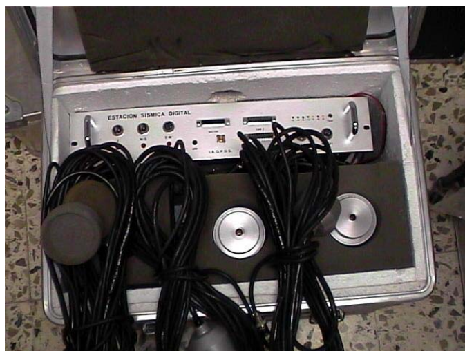
Figura 14.- Estación digital portátil autónoma. Está controlada por un PC portátil, en cuyo disco graba los registros. Se muestra la caja que aloja el sistema de adquisición de datos y el receptor GPS (muy voluminoso en estas primeras unidades) y la alimentación. También se transportan en ella los sensores de 1Hz y sus cables.
