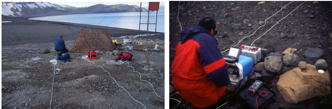
Figura 17.- Arrays desplegados en Isla Decepción (Antártida). Izquierda: La unidad de adquisición de datos está protegida por una tienda de campaña y en ella convergen los cables de los sensores, que habitualmente no superan los 300m de longitud. Derecha: Unidad central de un array en operación. En este caso está montado en el interior de una nevera, para aislamiento térmico.
