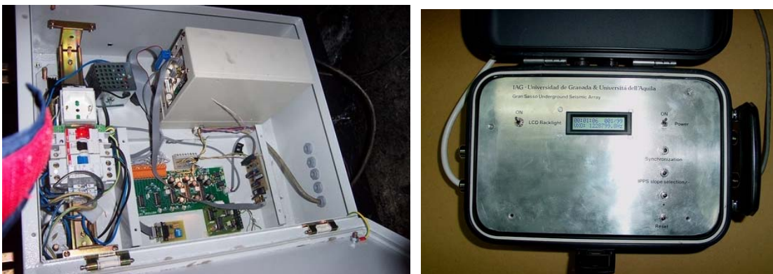
Figura 20.- Antena sísmica del LNGS. Izquierda: una estación. Se pueden ver el PC industrial (caja esquina superior dcha.), la tarjeta de conversión AD y los módulos de comunicaciones RS-485 y de PLL para generar la frecuencia local a partir de la piloto. Derecha: módulo de reloj central, que se sincroniza con un patrón atómico externo y genera la frecuencia piloto para las estaciones.
