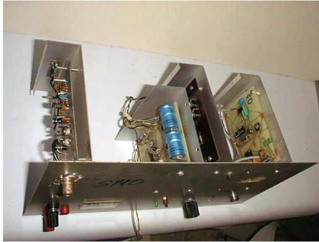
Figura 4.- Electrónica de la estación de campo telemétrica, versión 1980. Comprende cuatro módulos: de izquierda a derecha, transmisor de radio, alimentación simétrica, VCO y preamplificador. El conjunto se aloja en una caja con aislamiento térmico y ésta en una caseta metálica (ver fig. 5).
