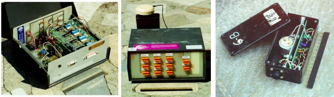
Figura 16.- Izquierda: sistema de adquisición de datos del array. La grabación y el control se realiza en un PC portátil. Derecha: los sensores son geófonos de 4.5 Hz, con un preamplificador-equalizador asociado para extender su respuesta a baja frecuencia.
