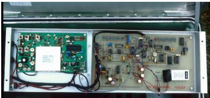
Figura 10.- Izquierda, electrónica de la estación de campo de la red portátil. Se muestra el transmisor de radio y la placa principal, que incluye el resto de la electrónica. Derecha, una vista de una de las instalaciones de esta red portátil, con la caseta en cuyo interior se aloja el sensor y la electrónica, el panel solar (el techo de la caseta es blanco para aprovechar la luz difusa, ya que el panel es bifacial) y la antena de transmisión.
