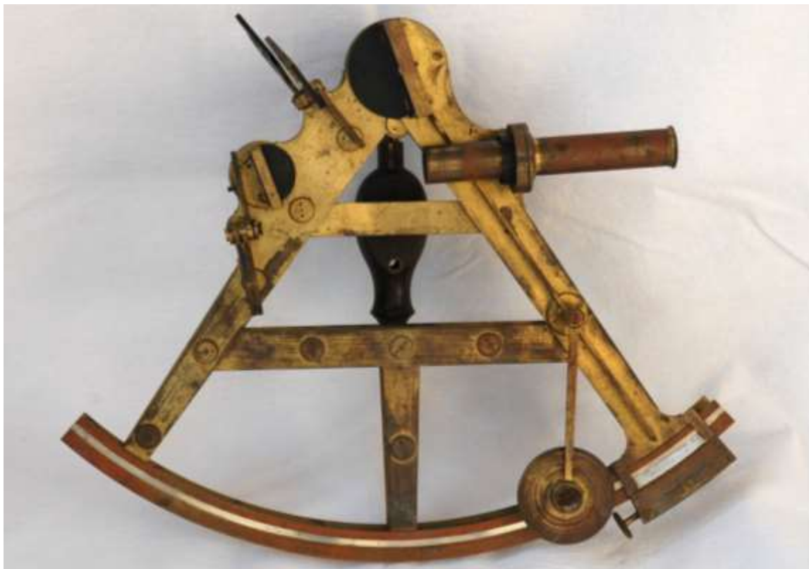
Sextante fabricado por E. Troughton, similar al usado en las observaciones realizadas en la sede de la Dirección Hidrográfica (C/Ballesta. Madrid)
