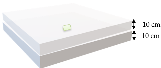
Figura 3.2. Esquema de la geometría formada por el maniquí de placas RW3 y la película radiocrómica EBT3 colocada en el punto central entre las 10 láminas de RW3 de 1 cm de espesor. Las medidas se realizaron a una profundidad de 10 cm. Referencia: elaboración propia.
