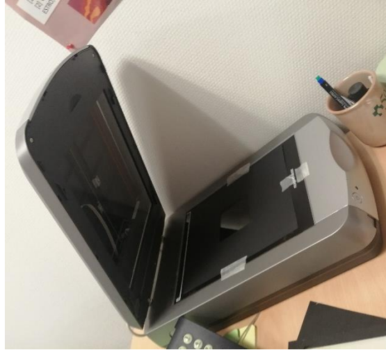
Figura 3.4. Escáner EPSON Perfection 4990 Photo con el que se han llevado a cabo los escaneados de los recortes de la película radiocrómica. Referencia: Hospital Universitario Clínico San Cecilio de Granada.
