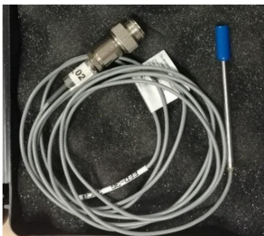
Figura 2.5. Diodo EFD 3G, de Iba Dosimetry. Referencia: Hospital Universitario Clínico San Cecilio de Granada.
