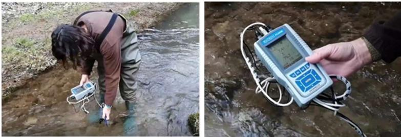
Figura 21. Ejemplo de muestreo con sonda multiparamétrica.
