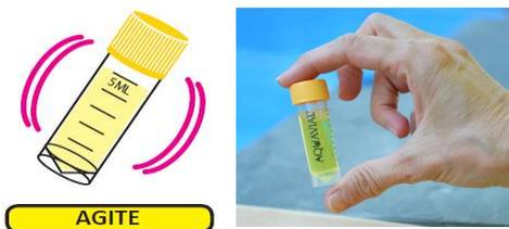
4. Incuba el vial colocándolo en una posición vertical a 35-40°C durante 24 horas o bien a 20-25°C durante 48 horas
