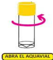
2. Llena el AquaVial™ con agua de muestra. La muestra de agua no debe exceder la línea de llenado de 5 ml. Gira la tapa amarilla en el sentido de las agujas del reloj para cerrar el vial. No dejes el frasco abierto.
