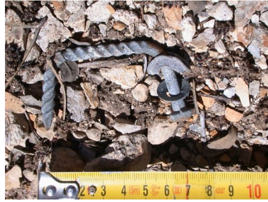
fig. 148.- Clavo de zinc estriado, específico para la instalación de chapas onduladas de fibrocemento sobre una armadura de madera, posición rebelde Cerro Pelado. Fidel Baena.
