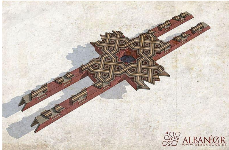
Fig. 77. Illustration des deux poutres ornées d'entrelacs. Notez l'entaille pour installer les taujeles . Dessin : Javier de Mingo, 2021. https://www.facebook.com/Albanecar.blog/photos/4170555983038052/
