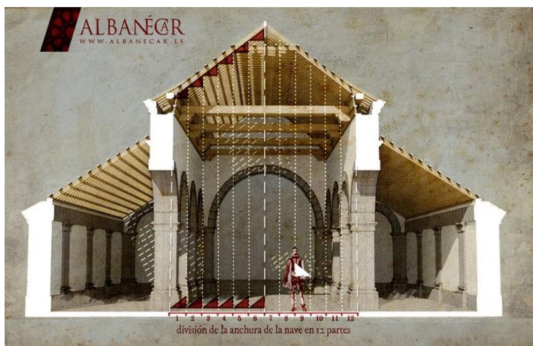
Fig. 67. Illustration de la division de la portée de la nef à couvrir en 12 parties. Illustration de Javier de Mingo, https://www.albanecar.es/el-metodo-arenas/ , 2017.
