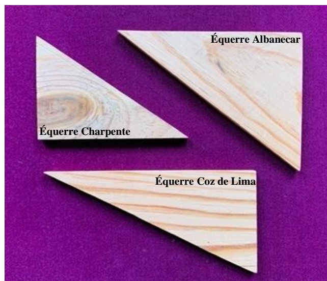
Fig. 61. Représentation matérielle des équerres utilisés pour la construction des charpentes. Photo : Francisco Mamani, 2022.
