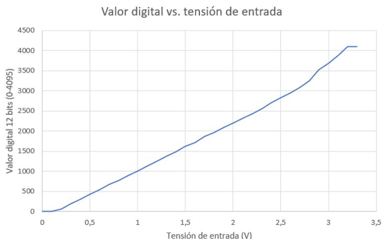
Figura 4.25: Voltaje (analógico) vs. lectura ADC (nivel digital) experimental
