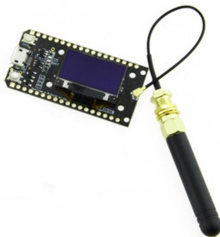
Figura 3.3: TTGO ESP32 LoRa v1 con antena de 868MHz
