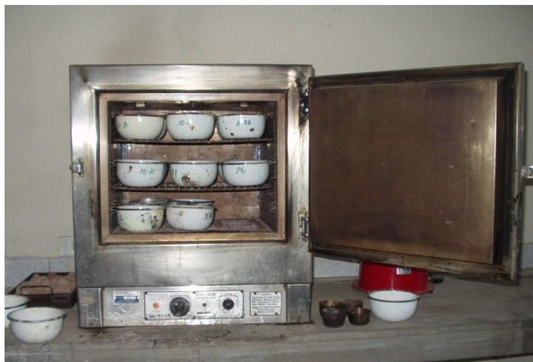
Figura 2.4: Estufa de laboratorio con muestras de tierra
