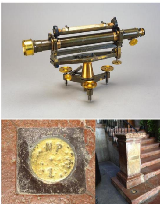
Nivel Kern de precisión (1870), junto a la primera señal de la Red de Nivelación colocada en el primer peldaño de la escalera principal del Ayuntamiento de Alicante.
