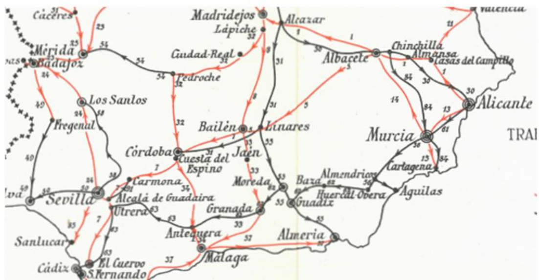
La Red de Nivelación de Precisión y detalle de las líneas del Sudeste. Las carreteras se dibujaron en rojo y las líneas de ferrocarril en negro. En los signos convencionales se representaron las señales principales, las señales de doble altitud y los polígonos de nivelación. Catálogo de las altitudes de las señales metálicas
