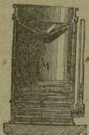
Fig. 4.ª - Interior del pluviómetro.
