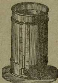
Fig. 5.ª - Exterior del pluviómetro.
