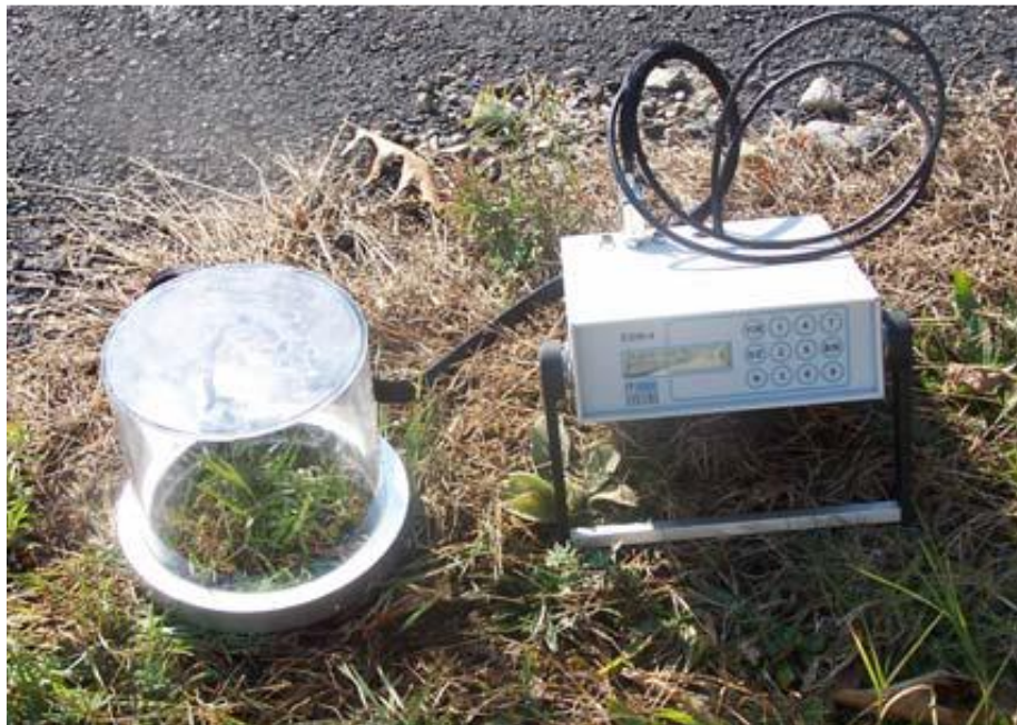
Figura 2. Imagen del sistema de medida de intercambios de CO 2 del suelo EGM-4/CPY-4. A la izquierda está la cámara colocada sobre un collar de PVC. Esta cámara es la encargada de captar y transportar el aire hasta la unidad control (a la derecha). En la unidad de control se analiza el contenido de CO 2 del aire mediante un analizador de gases por infrarrojo.
