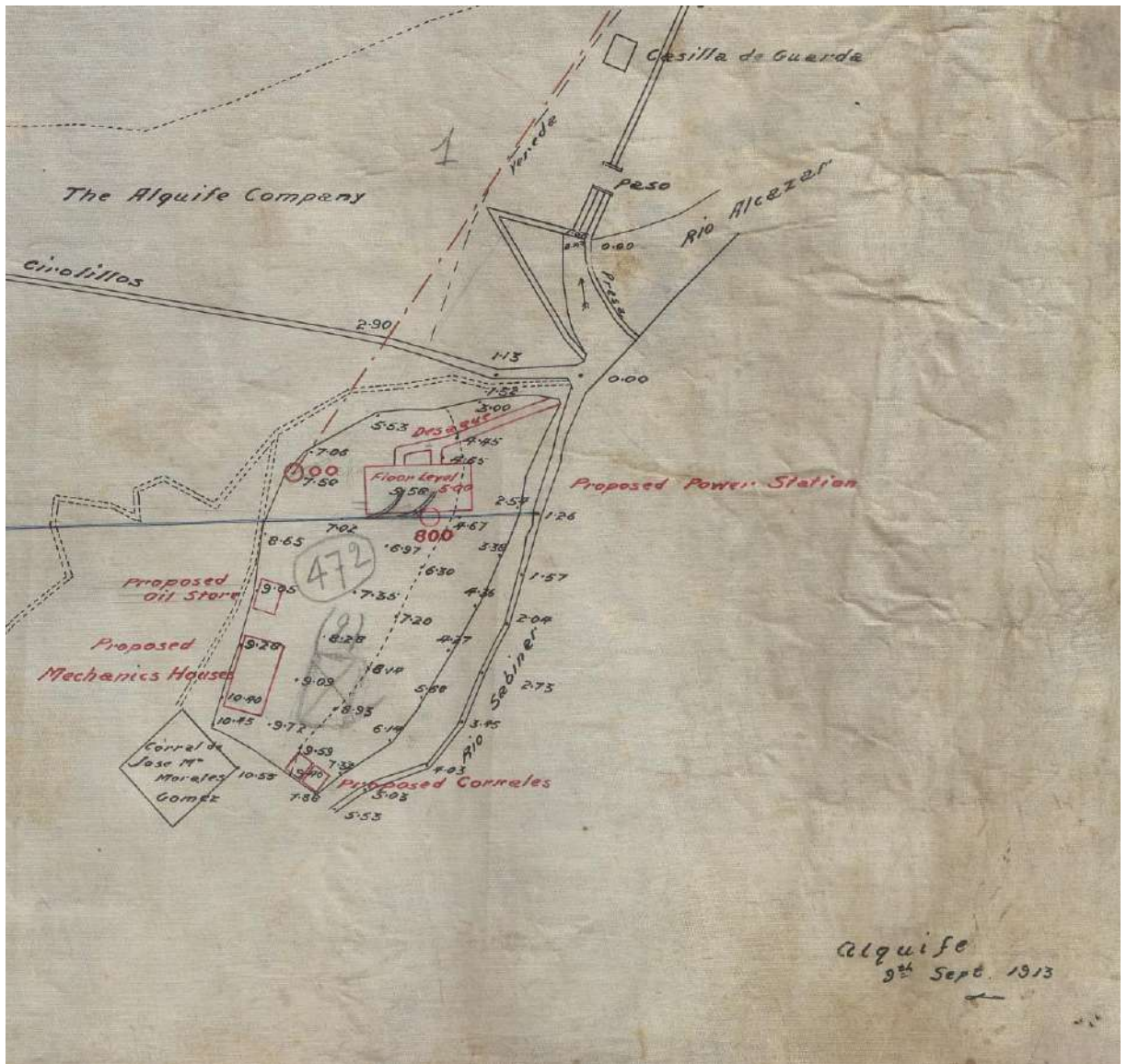
Plano 9. Sección del plano 8, de la central hidroeléctrica del Sabinar: casa de máquinas, canal de descarga, casillas de los maquinistas, e instalaciones auxiliares. Fuente: Archivo Minas de Alquife S.L.U, año 2018. Sin clasificar.
