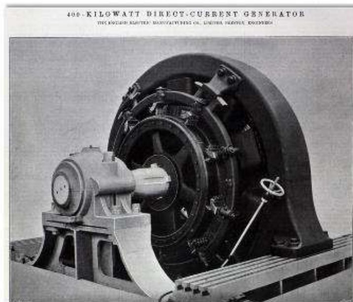
Figura 23. Modelo de Dinamo similar a la que se Instaló en la central del Sabinar.
