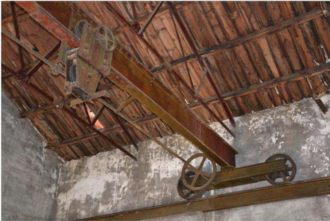
Figura 104. En el interior de la casa de máquinas de Alhorí II se encuentra todavía el puente grúa para el desplazamiento de maquinaria. Fuente: Fotografía del autor.
