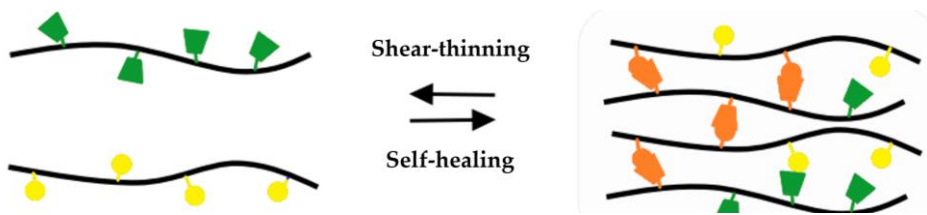
Figura II.2. Ilustración esquemática del ensamblaje (autorreparación, naranja) y rotura de la estructura del hidrogel. Imagen sacada de la ref 80 con permiso de Natureprotocols.
