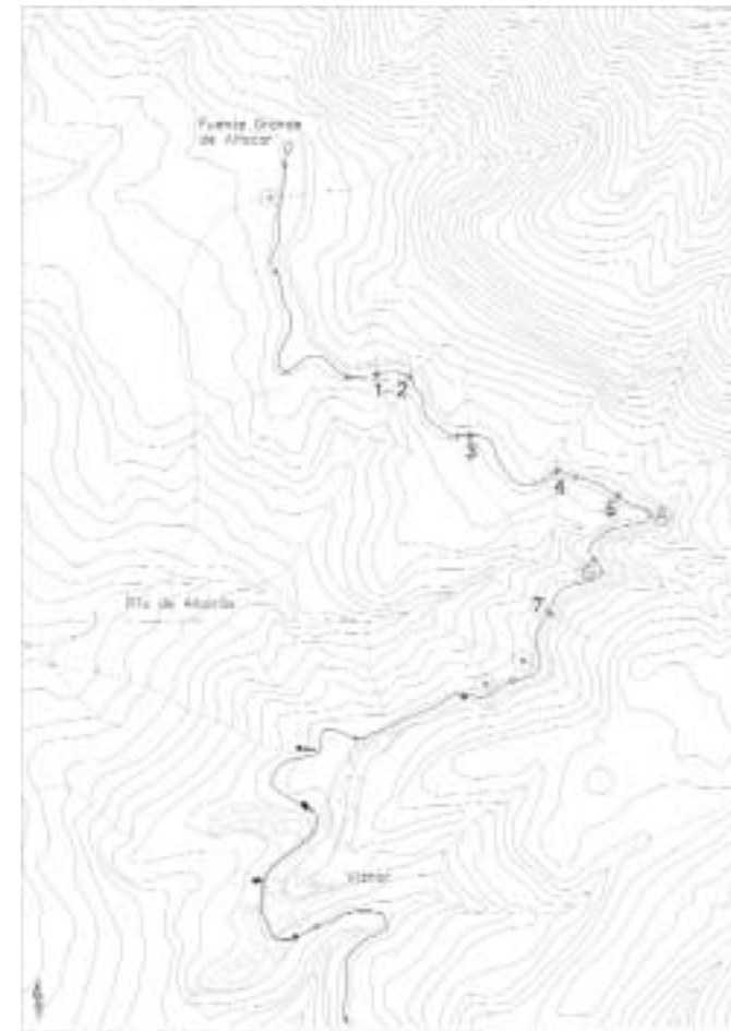
LA ACEQUIA DE AINADAMAR ENTRE LA FUENTE GRANDE DE ALFACAR Y LA LOCALIDAD DE VÍZNAR - Trozos históricos de la Acequia de Ainadamar 1 7 Puentes que mantienen una función similar a la original 2 Puentes reconstruidos en función actual 3 Puente (reconstruido) de los Tibones, Número 5 de la Alcantara 4 Ubicación hipotética de otros puentes reconstruidos por completo 5 Molinos históricos en el cauce de la acequia
