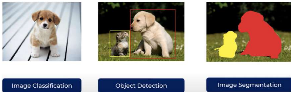
Figura 1: Tareas de deep learning como clasificación (izquierda), detección (centro), segmentación (derecha). Obtenida el 03 de diciembre de 2021 de https://venturebeat.com/2021/05/14/new-deep-learning-model-brings-image-segmentation-to-edge-devices/
