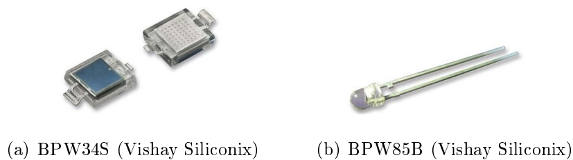
Figura 2.8: Fotodiodo y fototransistor estudiados.
