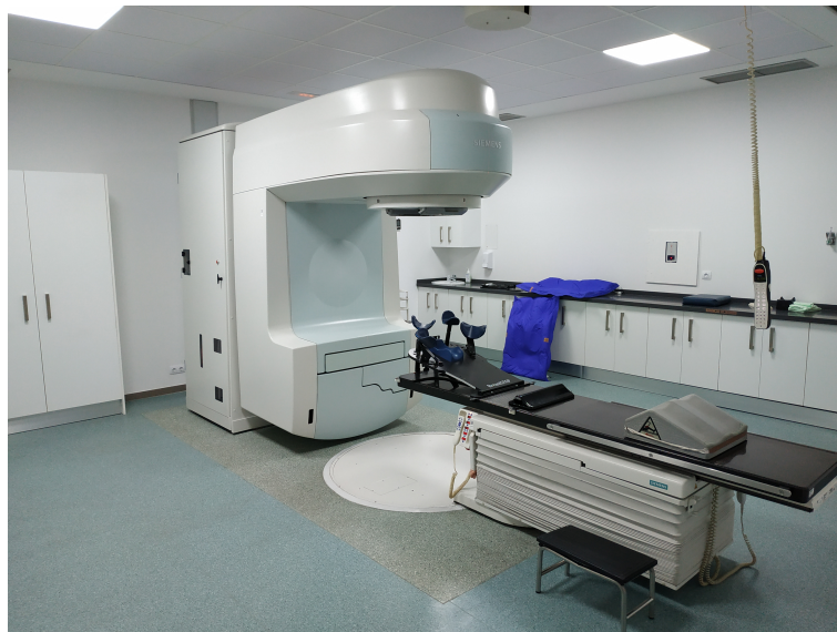
Figura 2.1: Acelerador lineal de electrones Siemens Artiste del Hospital Universitario San Cecilio de Granada.
