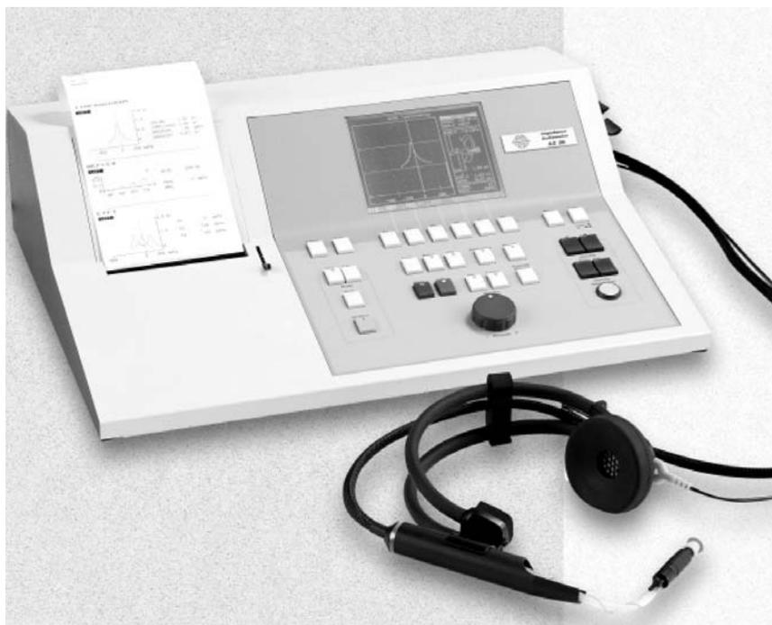
Figura 3.4: Vista frontal del impedanciómetro AZ26 utilizado par el registro del reflejo estapedial.
