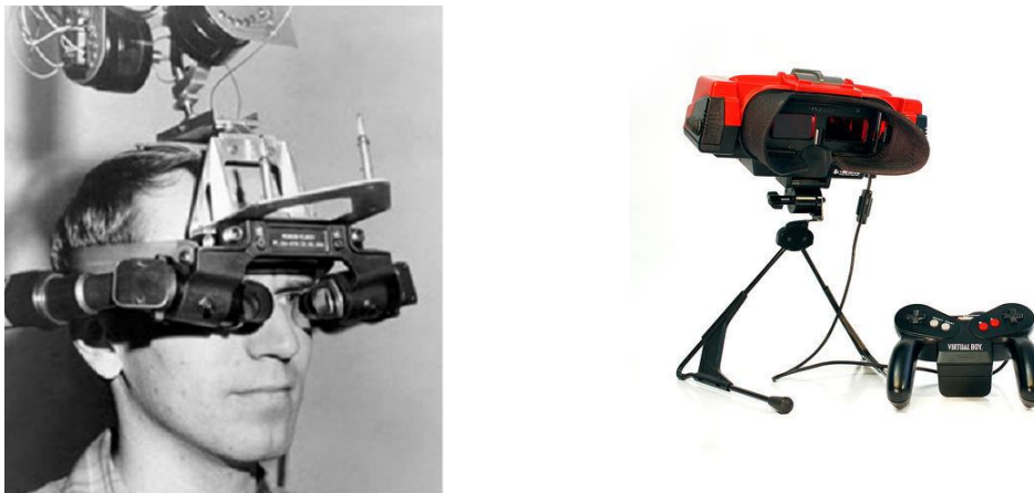
Figura 3. 3. A la izquierda, el sistema de RV conocido como "La espada de Damocles". A la derecha, el sistema Virtual Boy de Nintendo.
