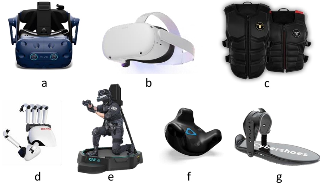
Figura 3. 5. Visores HMD y periféricos utilizados en RV. (a) HTC VIVE Pro Eye. (b) Oculus Quest 2. (c) Bionics Tactisuit x40. (d) Dexta Robotics Dexmo. (e) KAT Walk. (f) HTC VIVE Tracker. (g) Cybershoes 3D-run. Fuentes: [12]–[17].
