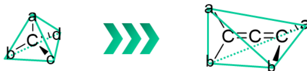
Figura 5. Modelo del tetraedro de Van't Hoff aplicado al eje quiral de un aleno.
