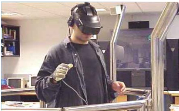
Fig. 46. Sistema de visualización inmersivo con dispositivo óptico, sonoro y capacidad háptica de interacción con el entorno virtual.
