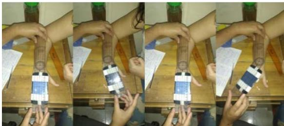
Figura 6: Aplicación versus goniómetro universal (movimiento de desviación ulnar y radial)
