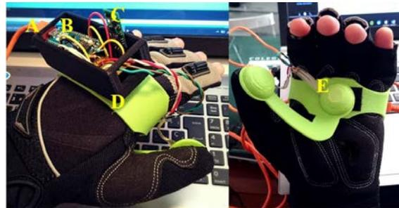
Figura 2: Vista general de la interfaz: A-conexión con el ordenador, B-Arduino, C-giroscopio, D-caja y correa, E-botón sobre un sensor FSR.
