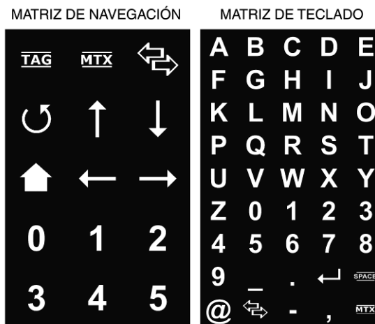
Figura 2. Matrices de comandos empleadas: (izquierda) navegación, (derecha) teclado.
