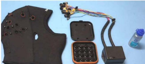
Figura 1: Gorro desarrollado para capturar señales de EEG.
