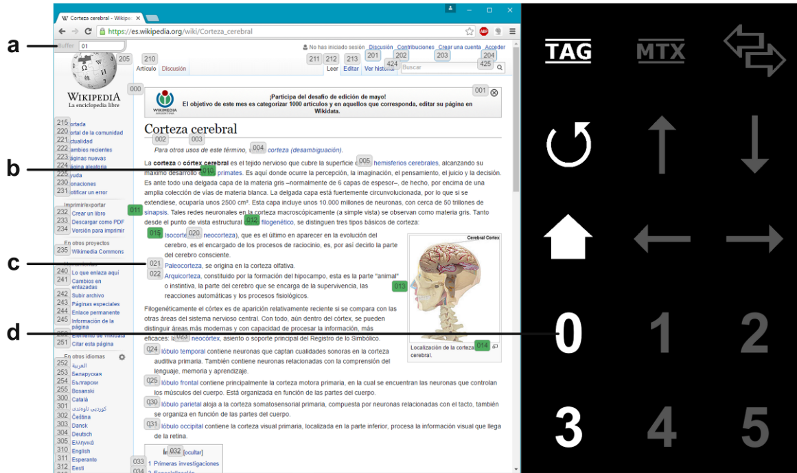
Figura 3. Interfaz de usuario: la matriz de comandos se muestra a la derecha de la pantalla y una página de Wikipedia en la parte izquierda. Como se muestra en el buffer (a), el usuario ha seleccionado “01” y, por tanto, las selecciones potenciales (b) se marcan en verde, mientras que el resto (c) se mantienen en gris. En esta captura, la primera columna de la matriz está siendo iluminada (d).
