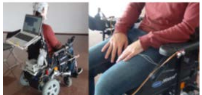
Figura 3: Silla de ruedas controlada por el sistema BCI
