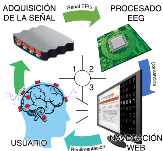
Figura 1. Estructura del navegador web BCI.
