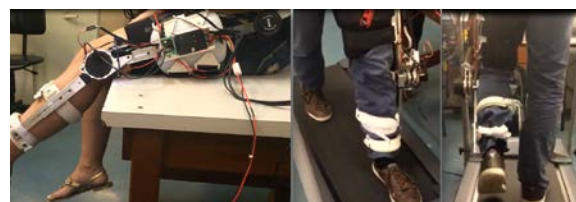
Figura 1: Exoesqueleto de rodilla ALLOR de la UFES, Brasil.
