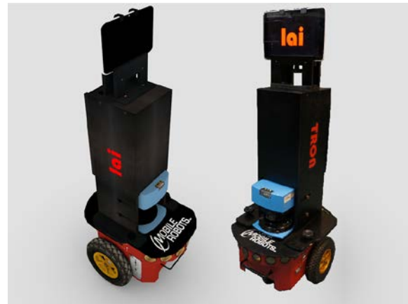
Figura 2: Robot de telepresencia virtual (izquierda) y real (derecha), denominado TRON ( Telepresence Robotic Navigation ), de UFES/Brasil.
