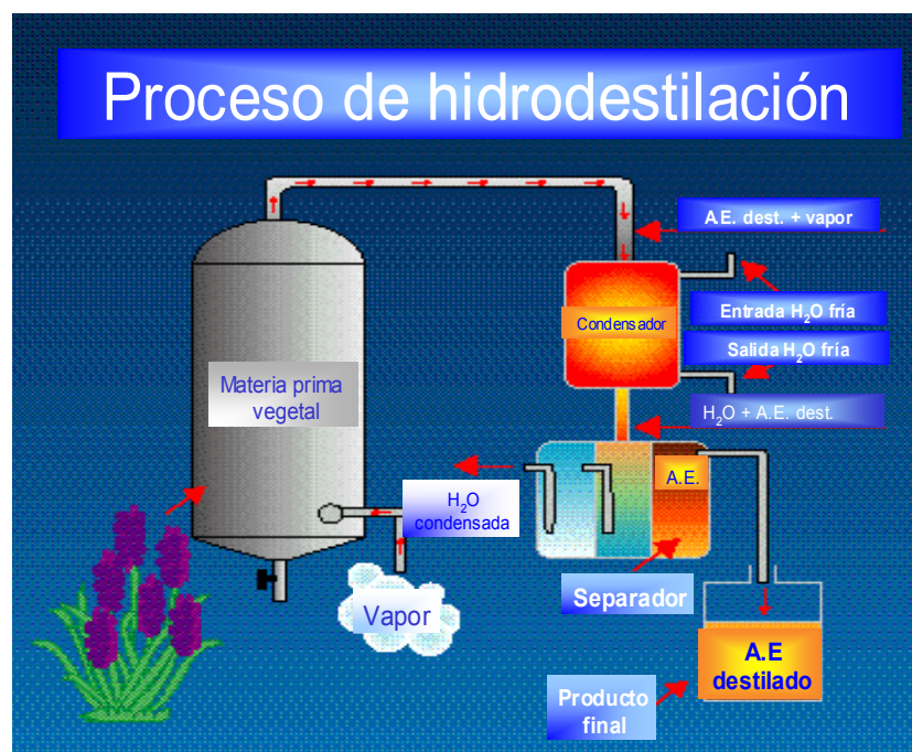
Figura 1. Proceso industrial de hidrodestilación.
