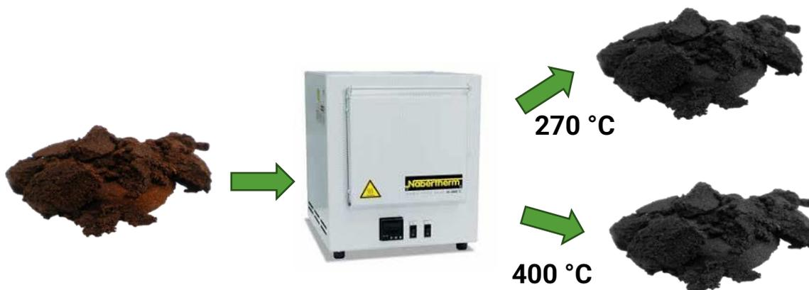
**Figura 25.** Procedimiento para la obtención de biochar de SCG.
