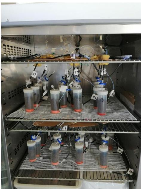
**Figura 37.** Sistema automatizado de muestreo para la medición continua de CO<sub>2</sub> y N<sub>2</sub>O.
