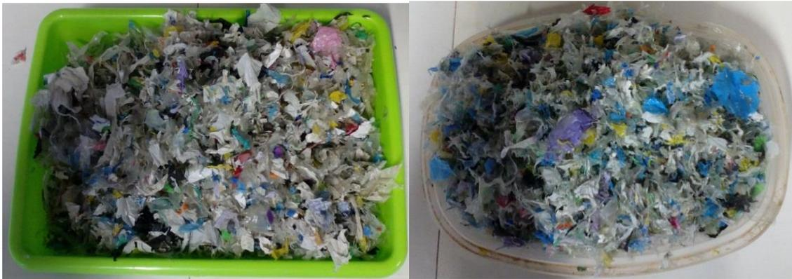
**Figura 4.1.** Muestras de plástico tras el lavado en el laboratorio de las muestras P-1, P-2 y P-3.
