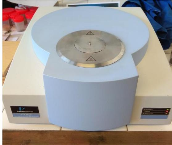
Figura 2.6. Balanza termogravimétrica Perkin Elmer.
