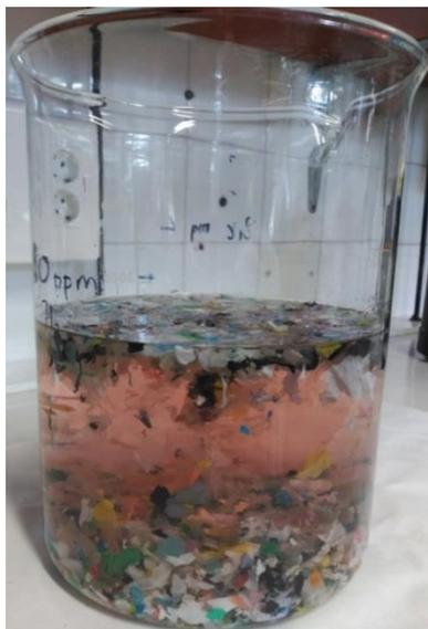
*Figura 4.14. Plásticos separados por densidad con una disolución etanol-agua, de la muestra A-3.*
