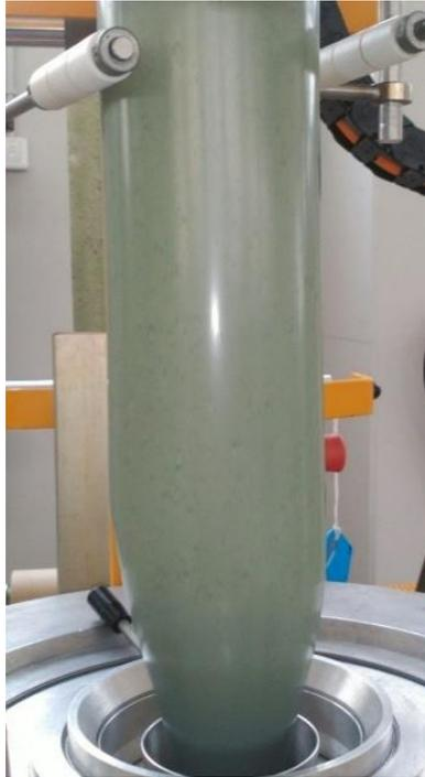
*Figura 4.26. Globo de film obtenido en el proceso de soplado.*
