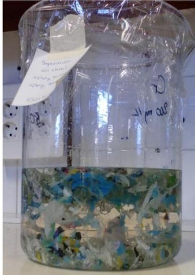
*Figura 4.5. Ensayo de flotación con la muestra P-1 en una disolución etanol-agua.*
