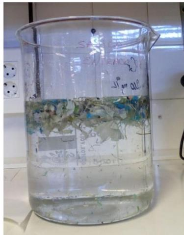
*Figura 4.4. Experimento de flotación en agua con la muestra P-1.*
