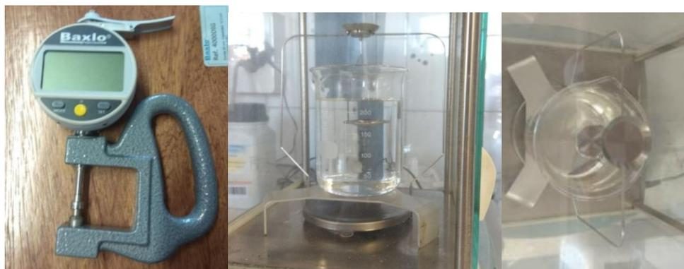
*Figura 2.4. Micrómetro Baxlo Precision (izquierda) y densímetro Mettler (centro y derecha).*
