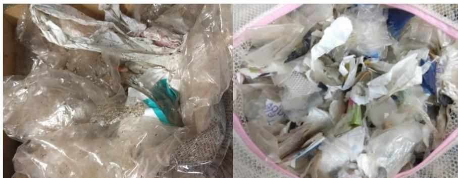
*Figura 2.20. Fotografías del plástico antes del lavado (izquierda) y después del lavado a temperatura ambiente (derecha).*
