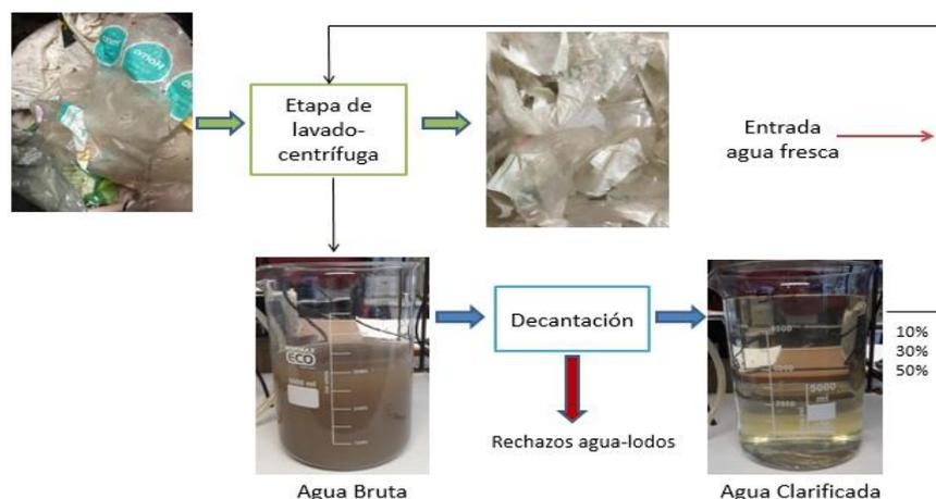
*Figura 3.3. Diagrama de flujo del proceso de lavado con agua recirculada sin secado previo.*
