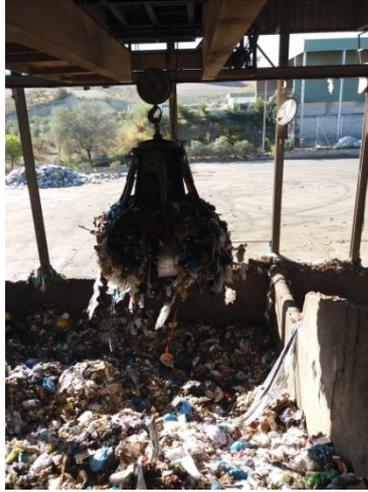
*Figura 1.26. Foso y pulpo electrohidráulico.*
