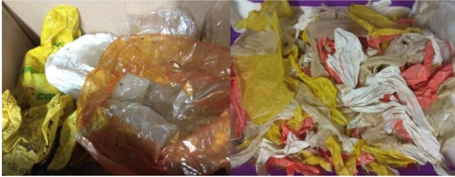
*Figura 2.22. Fotografías del plástico antes del lavado (izquierda) y después del lavado a 60°C+NaOH (derecha).*
