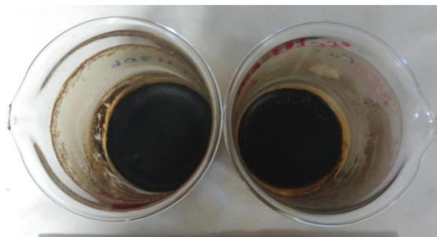
*Figura 4.13. Sólidos totales y sólidos disueltos del agua de desagüe.*
