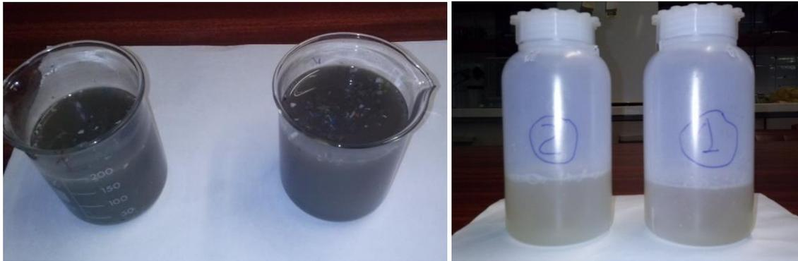
*Figura 4.6.* Agua original del proceso de lavado (A) y agua obtenida tras el proceso de filtración (B) en la planta de Portugal.
