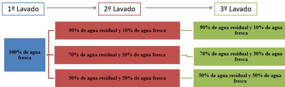
*Figura 3.2. Lavados realizados con recirculación del agua tratada y con diferentes proporciones de agua tratada/agua fresca.*
