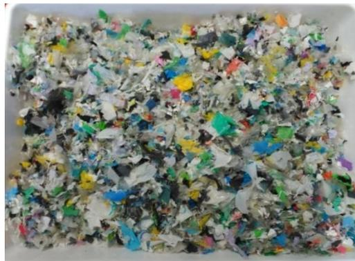
*Figura 4.11. Muestra A-3 limpia y seca tras el proceso de lavado en el laboratorio.*
