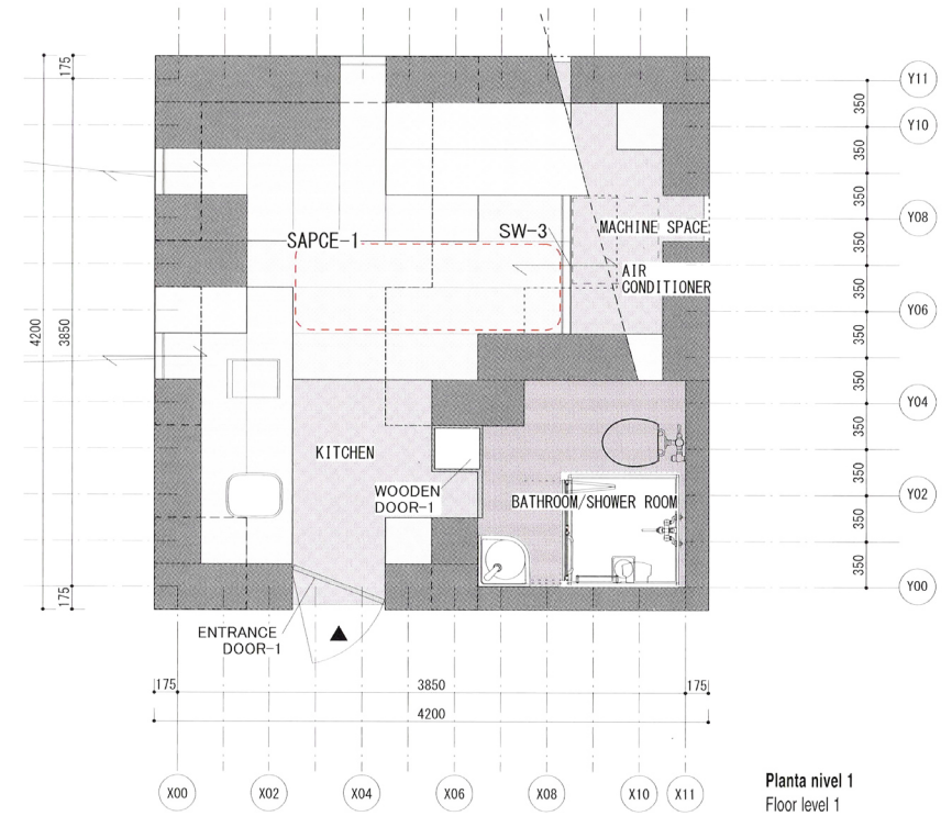
Planta de distribución Final Wooden House. Ilustración de El Croquis. 151 Sou Fujimoto 2003-2010.
