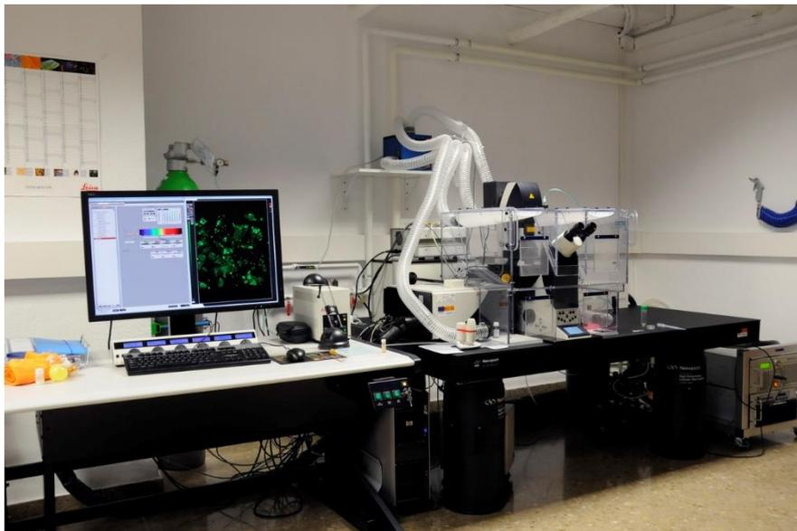
**Figura 3.6.** Microscopio Laser Confocal Espectral de Alta Velocidad y Multifotón Leica TCS-SP5 II.
