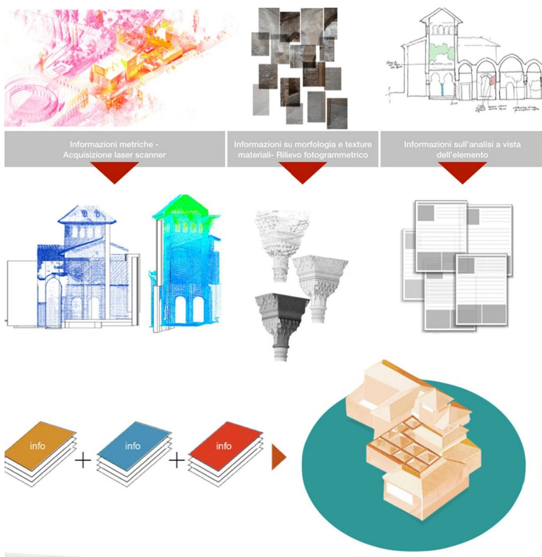
Figura 9. Il modello finale H-BIM sarà contenitore informativo a diversi livelli di approfondimento, sintesi delle considerazioni e delle attività di ricerca e di rilievo svolte.
