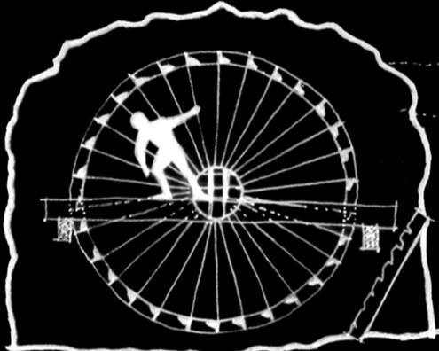
Sección longitudinal y planta de la EXTRACCIÓN DESAGÜE "a sangre" a través de Noria
