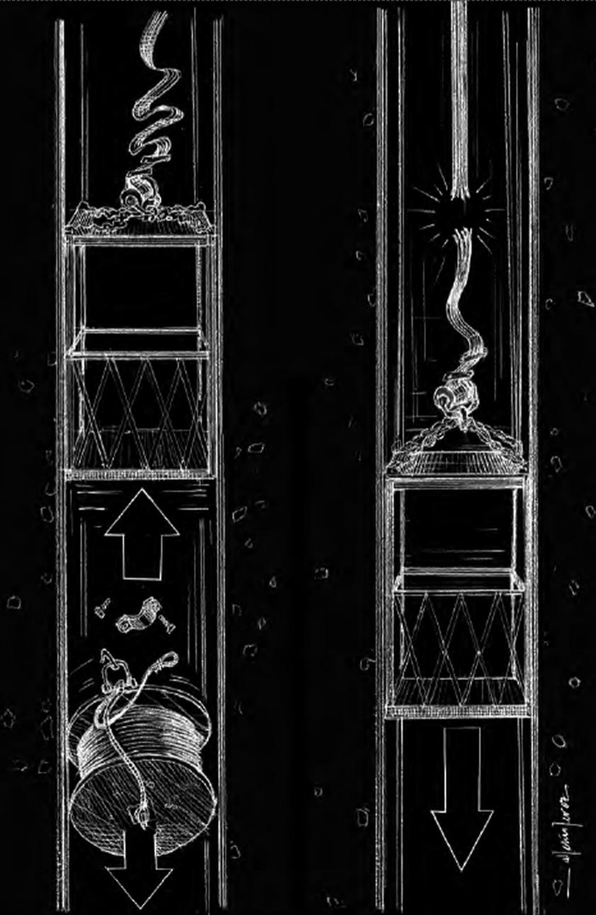
Secuencia del desprendimiento del carrete y del retroceso y caída de la jaula. (Se omite dibujar a los mineros).
