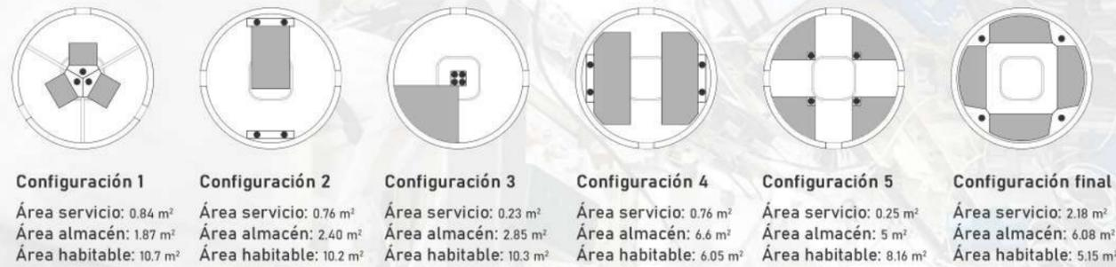
Figura 3.10: Diferentes configuraciones de sección en la fase de diseño. Áreas de servicio, almacenamiento y habitable. Elaboración propia.
