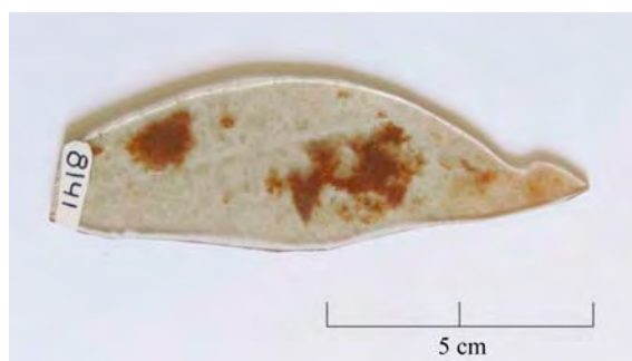
Fig. 160. Depósitos de gossan en la superficie de uno de los fragmentos de vidrio de ventana romano del yacimiento de Cortalago (Minas de Riotinto, Huelva) (COR_77) (A. Velo Gala).
