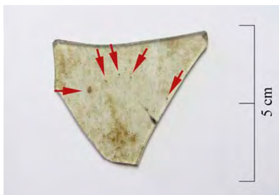
Fig. 194. Presencia de infundidos (señalados por las flechas rojas) en la masa del vidrio de uno de los fragmentos de vidrio de ventana romano de la villa de Ronda del Marrubial (A. Velo Gala).
