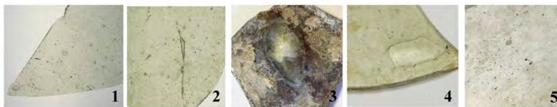
Fig. 173. Presencia de burbujas de aire en los fragmentos de vidrio de ventana de la Bética: (1-2) burbujas esféricas y alargadas, imagen con luz transmitida (MA_198 y MA_07); (3-4) burbujas de grandes dimensiones (AC_22 y MA_93); (5) orificios provocados por burbujas cerca de la superficie (MA_47) (A. Velo Gala).
