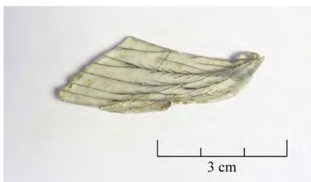
Fig. 193. Grietas de tipo pluma en un fragmento de vidrio de ventana romano procedente de la villa de Ronda del Marrubial (Córdoba) (A. Velo Gala).
