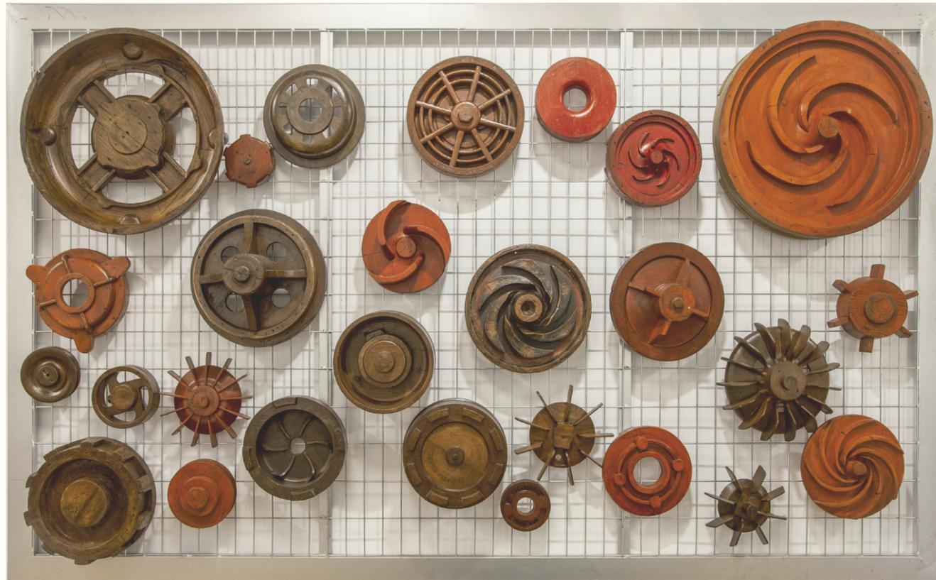
Modelos de madera para fundición
