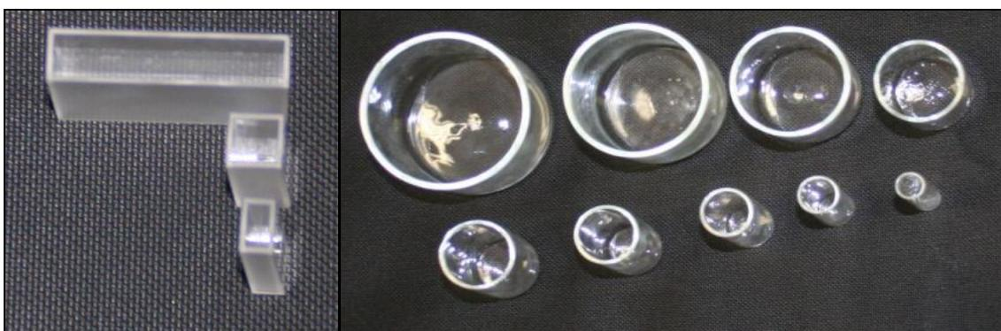
Figura 2.2: a) Cubetas de cuarzo utilizadas para las medidas espectrofotométricas. b) Cubetas de vidrio Pyrex usadas para las medidas espectrorradiométricas.
