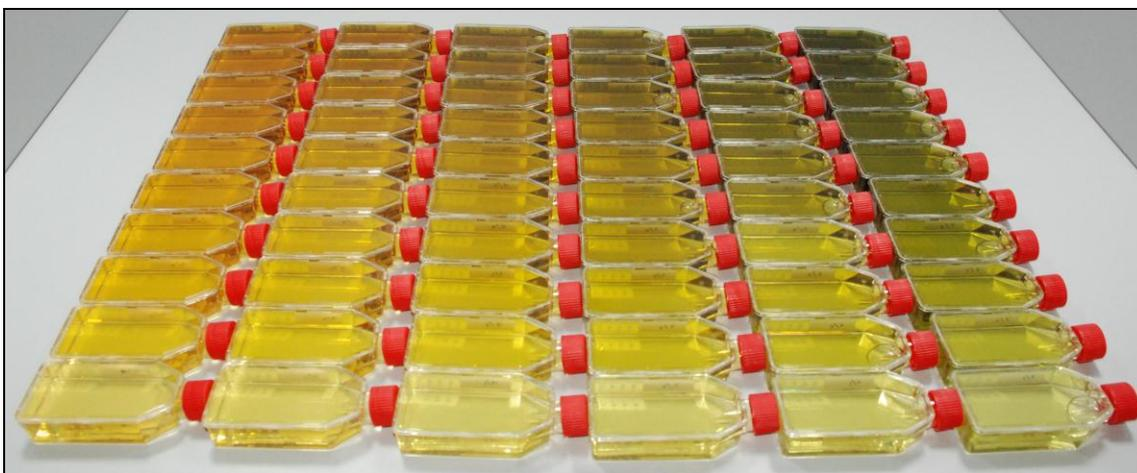
*Figura 5.6: Fotografía de los 60 patrones ABT utilizados para caracterizar el dispositivo.*
