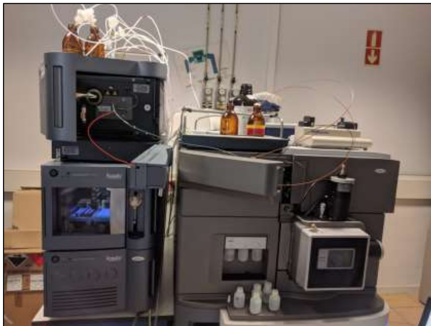
Lámina 1.7: Cromatógrafo de Líquidos de ultra-alta presión acoplado a un espectrómetro de masas de alta resolución empleado en esta Tesis Doctoral (Laboratorio Centro Instrumentación Científica, Universidad de Granada).
