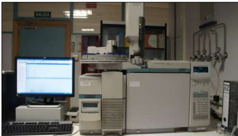
Lámina 1.6: Cromatógrafo de Gases Agilent 5890 empleado en esta Tesis Doctoral (Laboratorio Química Analítica, Universidad de Granada)
