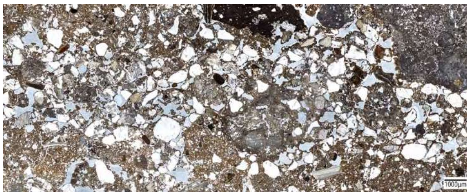
Fig. 183: Microfacies tipo 4.3, Arena de cuarzo bien clasificada
