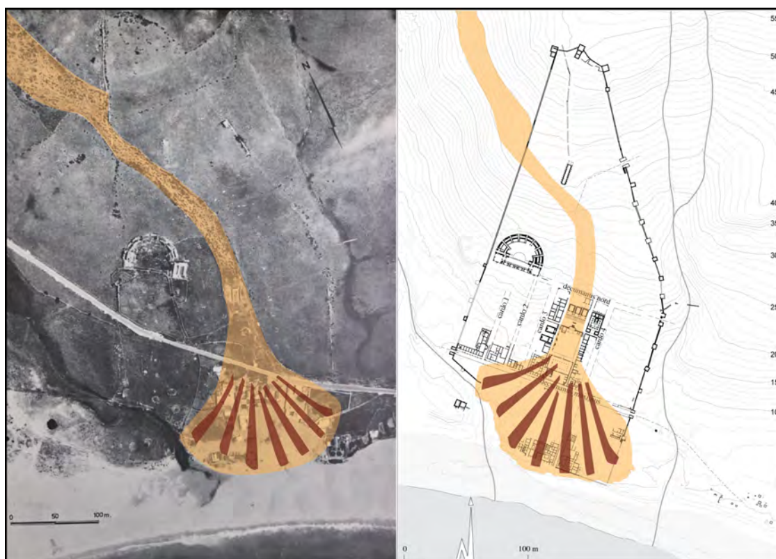
Fig. 314: Canal y abanico aluvial desarrollado a partir de época post-romana, denominado "Colada Mambru": A) Es visible en fotografías aéreas históricas de 1965, que demuestran el transporte aluvial de material fino por escorrentías generadas por la lluvia; B) El canal y su abanico aluvial asociado se reflejan en la topografía local mediante curvas de nivel.
