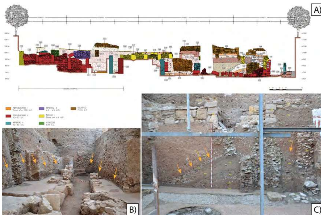
Fig. 165: Sección acumulativa. En rojo el edificio tardorrepublicano, mostrando evidencias de desplomes traumáticos desde el sur, dirección en la que se encuentra el río Guadalquivir; B) Cimientos alterados por el evento; C) Extensión del aporte sedimentario del evento del siglo III (flechas naranjas en B y C) (Tabales Rodríguez, 2015)
